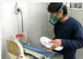
⑦ ホリゾンタルマシーンで 前額面アライメント補正を確認しながら底面を削ります。その他 順に水平面 矢状面の加工も厳密な角度に削り仕上げを行います。ここまでで適切な分圧が足底面に出来るような基本部分の完成となります。
